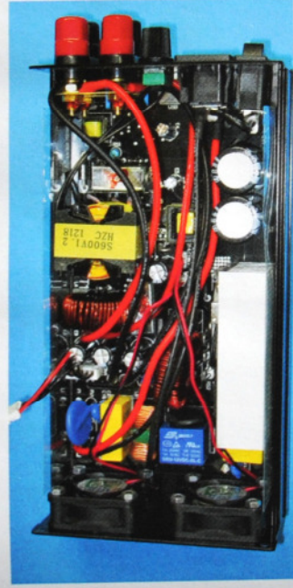
Die Innensicht des S600 lässt die kompakte und raumsparende Bauweise gut erkennen. Die digitalen Strom- und Spannungsinstrumente sind am Gehäusedeckel angebracht und lassen sich beim Öffnen leicht abstecken.
