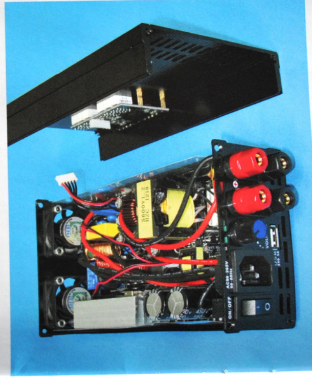
Die Innensicht des S600 lässt die kompakte und raumsparende Bauweise gut erkennen. Die digitalen Strom- und Spannungsinstrumente sind am Gehäusedeckel angebracht und lassen sich beim Öffnen leicht abstecken.
